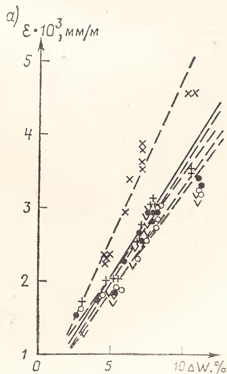
Рис. 1. Зависимость деформаций от изменения влажности при усадке (а) и набухании (б) арболита
